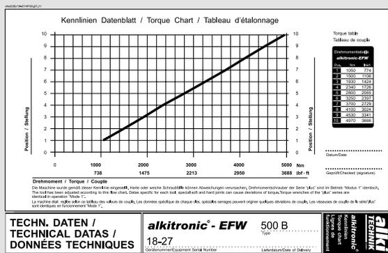
Kennlinien-Datenblatt (Beispiel EFW 500) mit Drehmomenttabelle zur Ermittlung von Drehmomentwerten. Dem Abschalt Drehmoment ist eine Positionszahl zugeordnet. Im Bedienbereich kann die gewünschte Position mit den +/- Tasten ausgewählt werden. Ein LED zeigt den aktuell gewählten Wert an (Bild linke Seite, Modelle alkitronic® EF/EFW).
